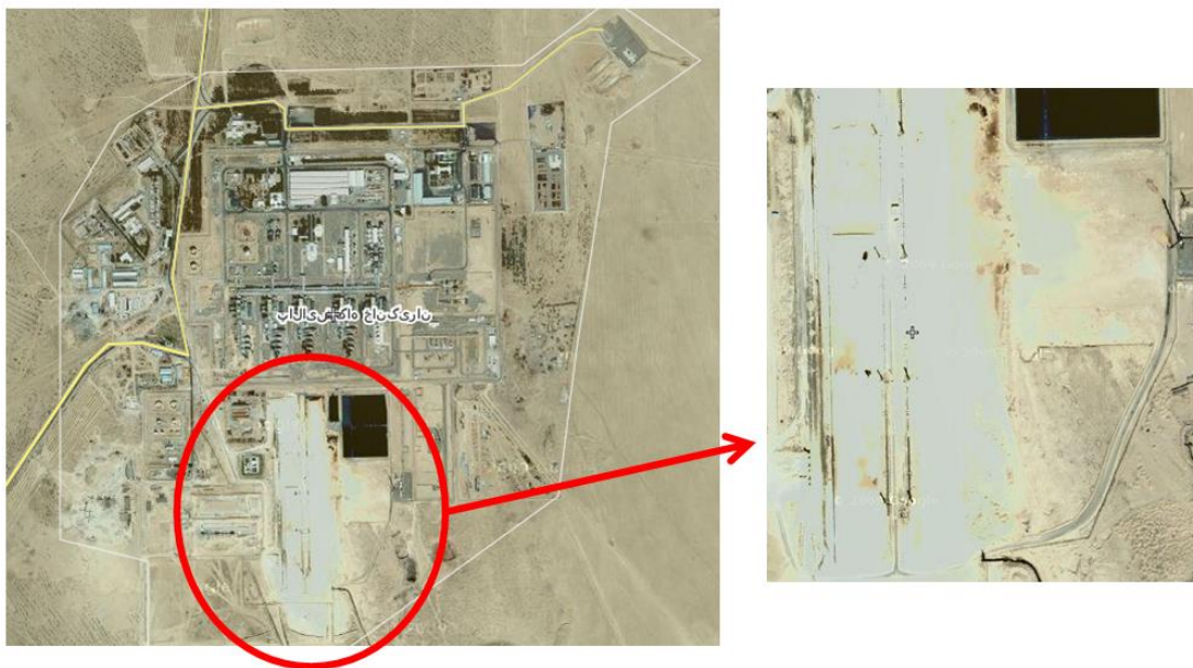
شکل (۵-۱) انتشار ذرات گوگردی به اطراف بلوک های گوگرد در پالایشگاه گاز خانگیران
