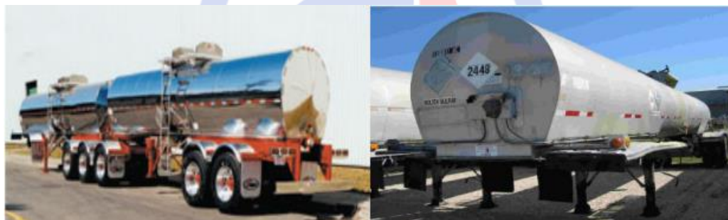
شکل (۴-۶) نمونه ای از تانکرهای حمل گوگرد مذاب، راست) تک تریلیر - چپ) دو تریلیر
